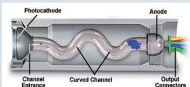
Преимущества канального фотоэлектронного умножителя. Канальные ФЭУ имеют много общего с классическими ФЭУ, но обладают улучшенными свойствами: низкие значения темнового тока, более высокий коэффициент усиления, более высокая чувствительность и низкий шум
